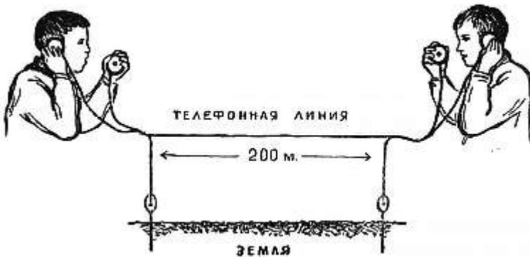
Рисунок 2. Схема использования самодельного телефона [23, с. 120]
